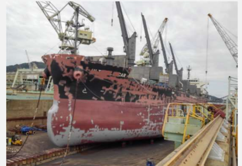
〔塗装工事中の本船〕
